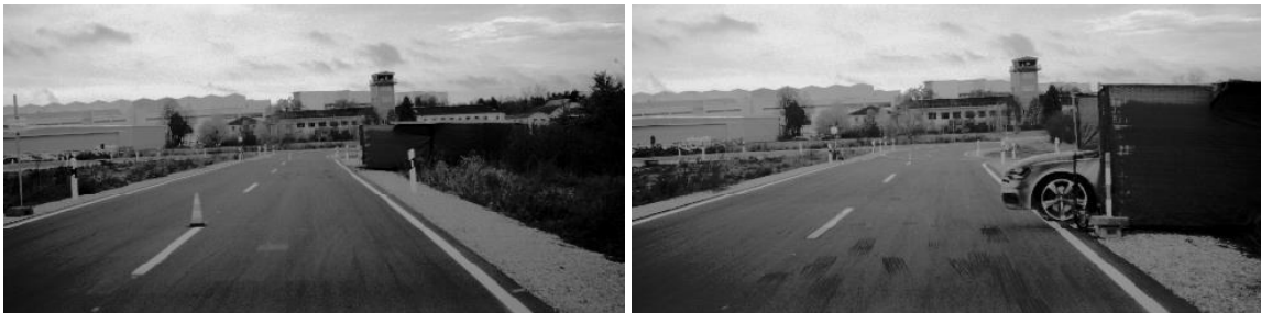
Abbildung 1: CAPLOS im ein- (links) und ausgefahrenen Zustand (rechts) bei Annäherung (aus Szenario B)
