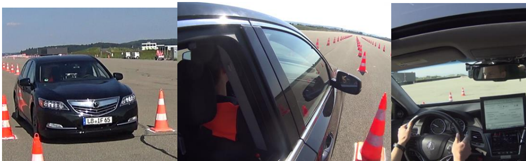
Abbildung 4: Versuchsfahrzeug innerhalb der Pylonengasse (links, Mitte) und Innenansicht inklusive des Bildschirms zur Auswahl und Auslösung des Fehlerbilds durch den Versuchsleiter (rechts).
