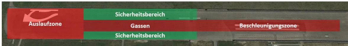
Abbildung 3: Schematische Darstellung des Aufbaus der Prüfscenarien auf dem Prüfgelände.
